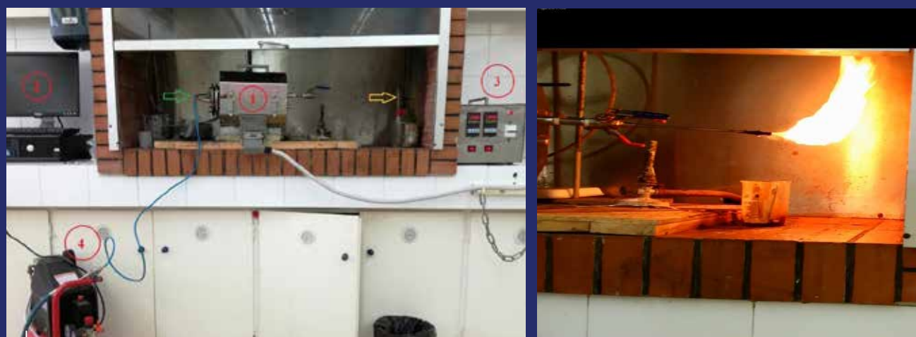
Figure 2 – Schéma annoté du montage pilote de gazéification mis en place au laboratoire de la Faculté des Sciences Université Saint-Joseph de Beyrouth
