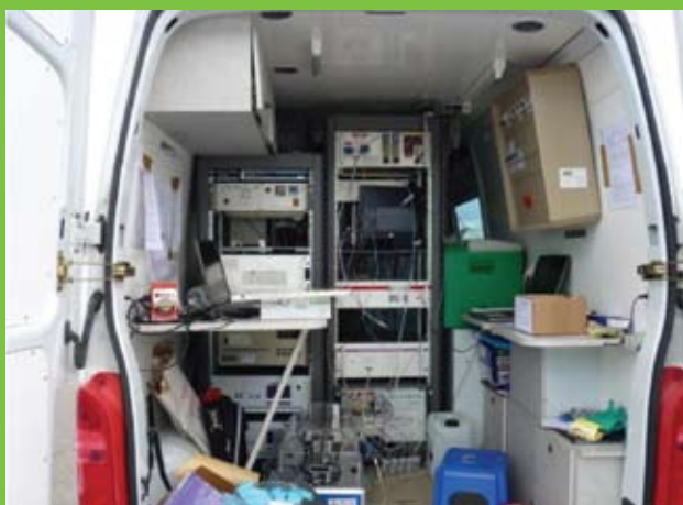
MILEAGE : laboratoire mobile du LISA implémenté durant les deux campagnes au site de l'école polytechnique À gauche : vue de l'intérieur, à droite : vue de l'extérieur durant l'installation en janvier 2010.
