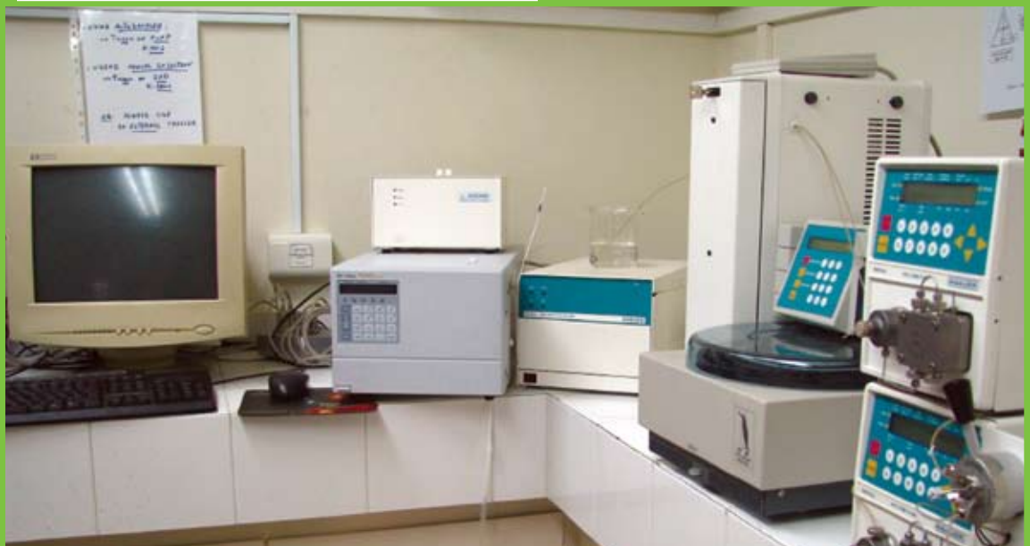
Chromatographie liquide à haute performance couplée à une détection fluorimétrique utilisée dans le dosage des mycotoxines.
